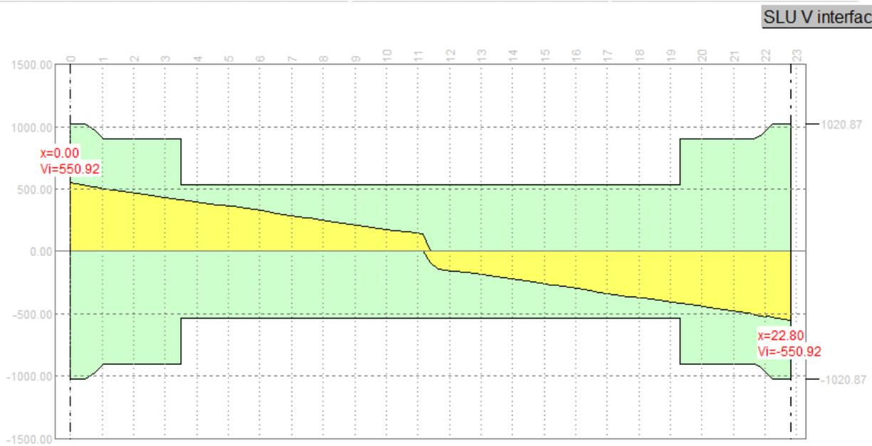
Figura 20 - Scorrimento interfaccia trave-soletta SLU
