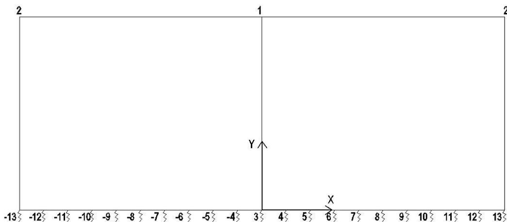
Figura 3. Numerazione dei nodi nel modello strutturale.
