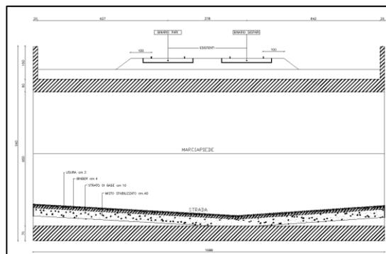
Figura 1b. Sezione longitudinale dello scatolare
