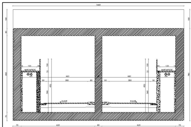
Figura 1c. Sezione trasversale dello scatolare
