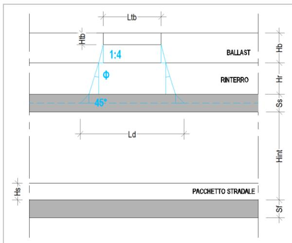
Figura 7. Schema modalità di diffusione dei carichi ferroviari
