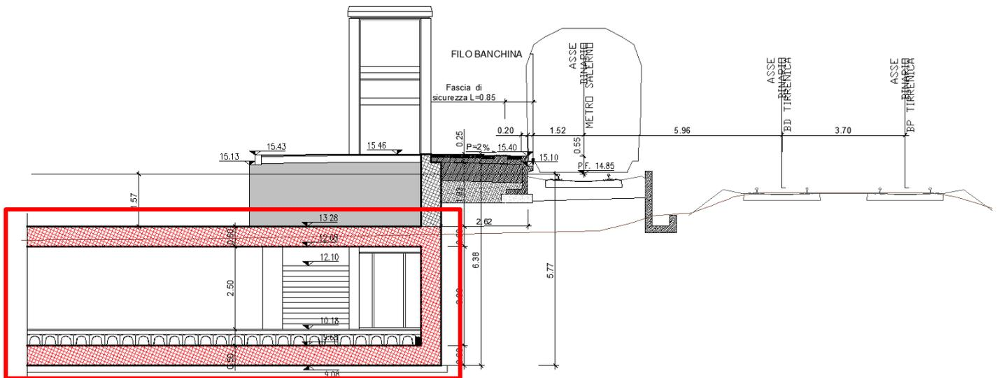
Figura 1b. Sezione trasversale dell'opera con individuazione del sottopasso
