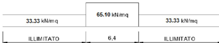
In conclusione nell'opera in oggetto la ripartizione del carico a quota del piano di regolamento è stata effettuata considerando una distribuzione in senso trasversale secondo una pendenza di 1 a 4 all'interno del ballast per cui risulta:
