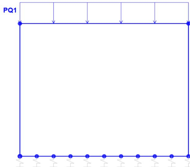
Figura 11. Condizione di carico ACCM da SAP2000
