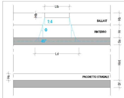
Figura 9. Schema modalità di diffusione dei carichi ferroviari
