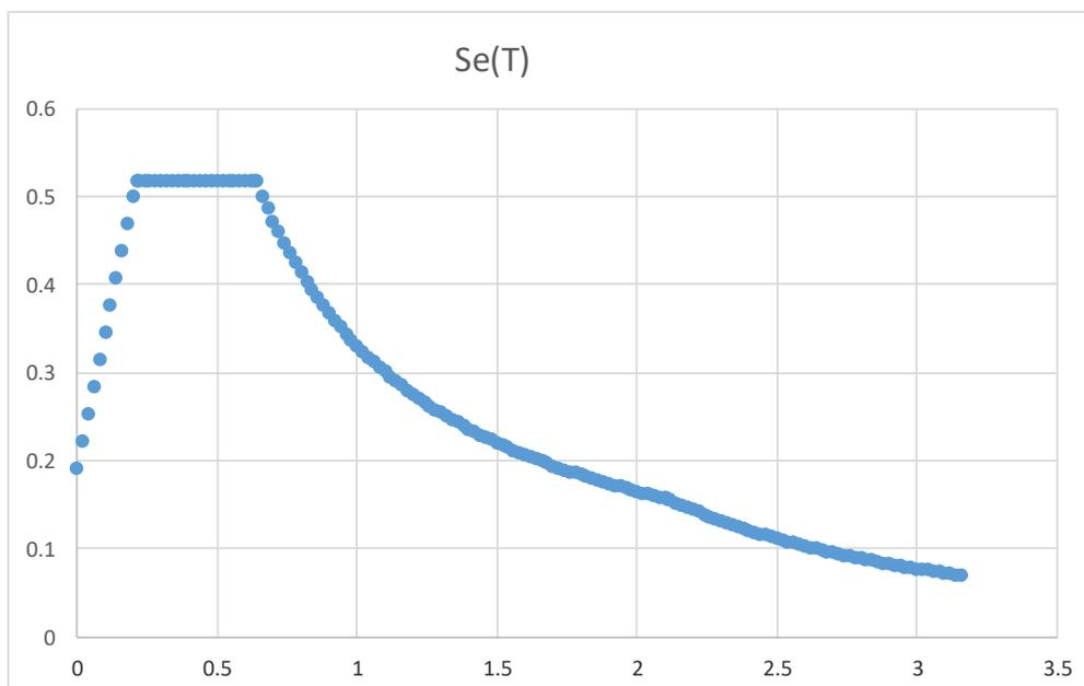
**Accelerazioni per il calcolo delle forze di inerzia agenti sullo scatolare**
