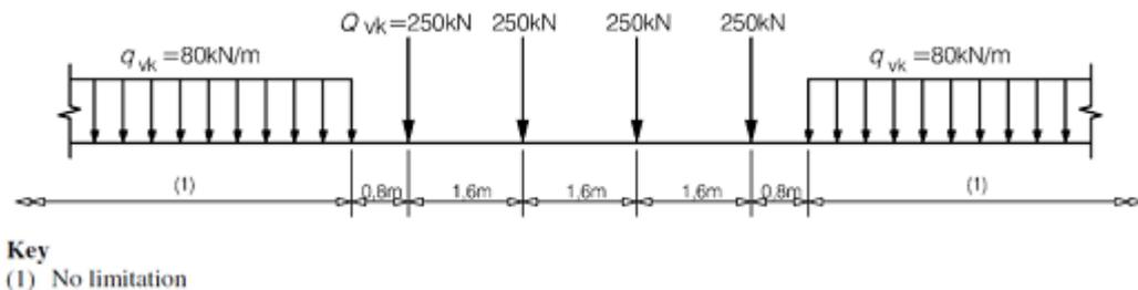
Il carico equivalente si ricava dalla ripartizione trasversale e longitudinale dei carichi per effetto delle traverse e del ballast previsti dalla stessa norma EN 1991-2:2003/AC:2010.
