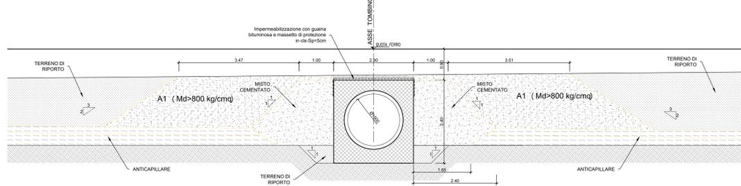
SEZIONE LONGITUDINALE: MONOLITE 1-2 IN POSIZIONE DI VARO
