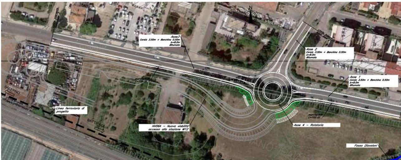
Figura 53: Stralcio planimetrico – NV06B\_Adeguamento dell'intersezione su SS18 e riprofilatura rami di innesto
