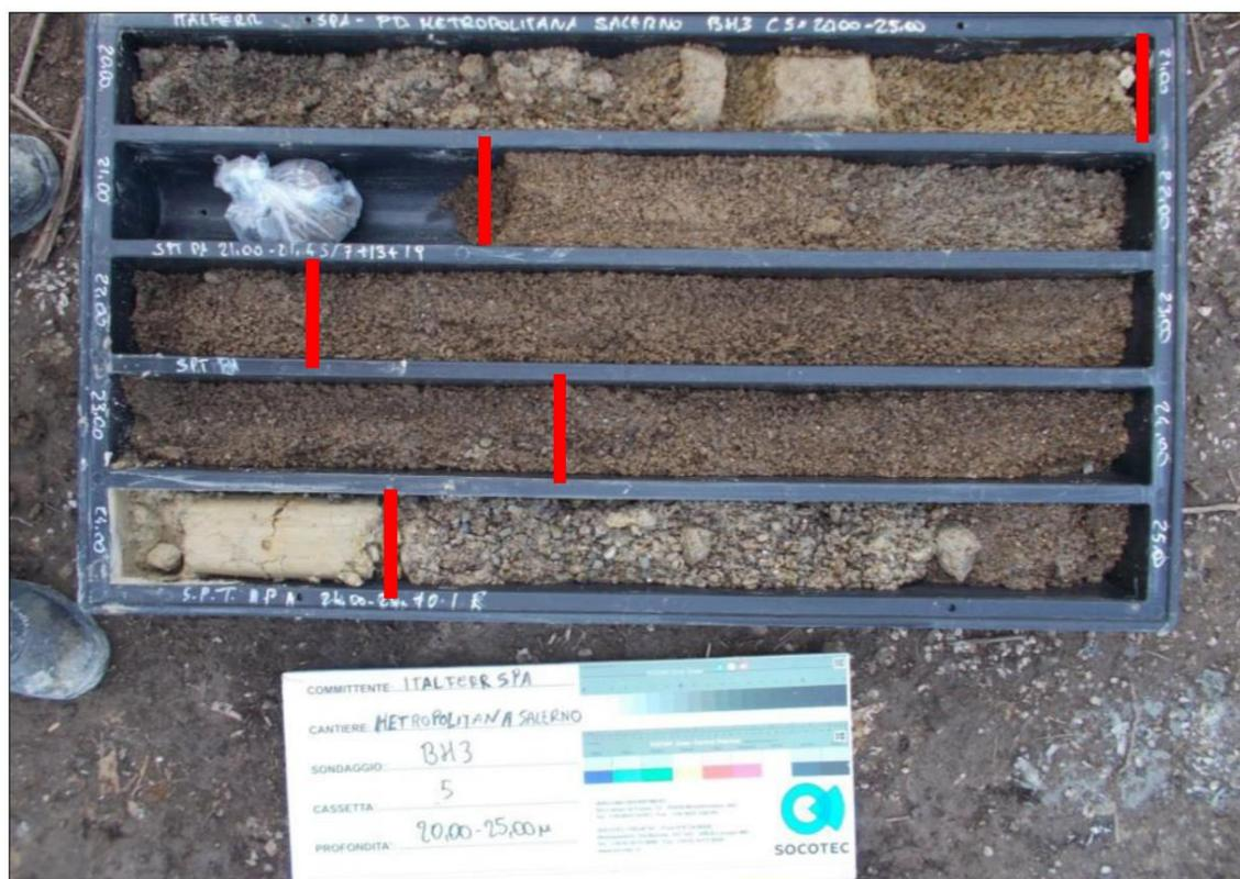
*Sondaggio BH3- profondità 20-25 m – descrizione 17.00 – 25.00 m: Ghiaie medie e medio grossolane eterometriche, sabbiose moderatamente addensate ad addensate debolmente umide, umide.*
