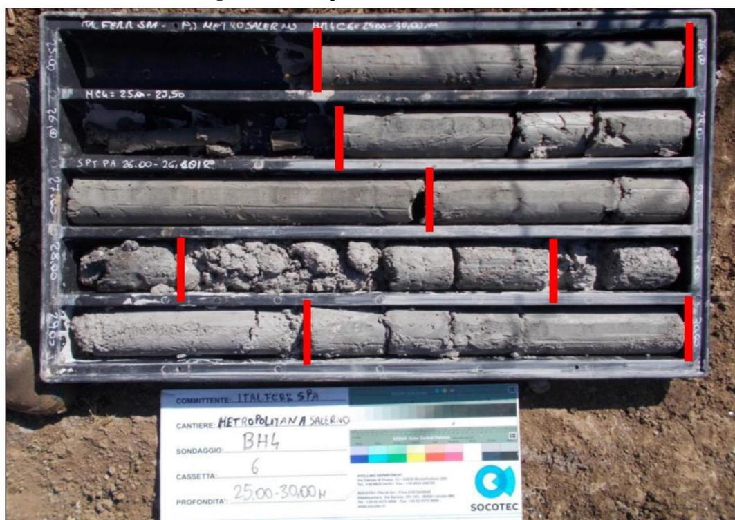
*BH4 – profondità 25 – 30m: descrizione 24.50 – 28.00m: Argilla grigia molto consistente umida (Argilla Rigida) talora sabbiosa; descrizione 28.00 – 30.00m: Argilla ciottolosa (con diametro massimo di 7 cm) a struttura brecciata, molto addensata/consistente umida.*
