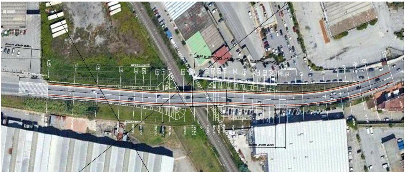
L'intervento prevede la modifica della viabilità esistente per circa 300m mediante un andamento plano-altimetrico compatibile sia con il raccordo alla viabilità esistente, facendo particolare attenzione agli accessi esistenti, sia con i franchi liberi richiesti in corrispondenza dell'opera di attraversamento in cavalcaferrovia (IV01). Sono stati utilizzati i criteri e le caratteristiche progettuali di cui ai paragrafi successivi.
