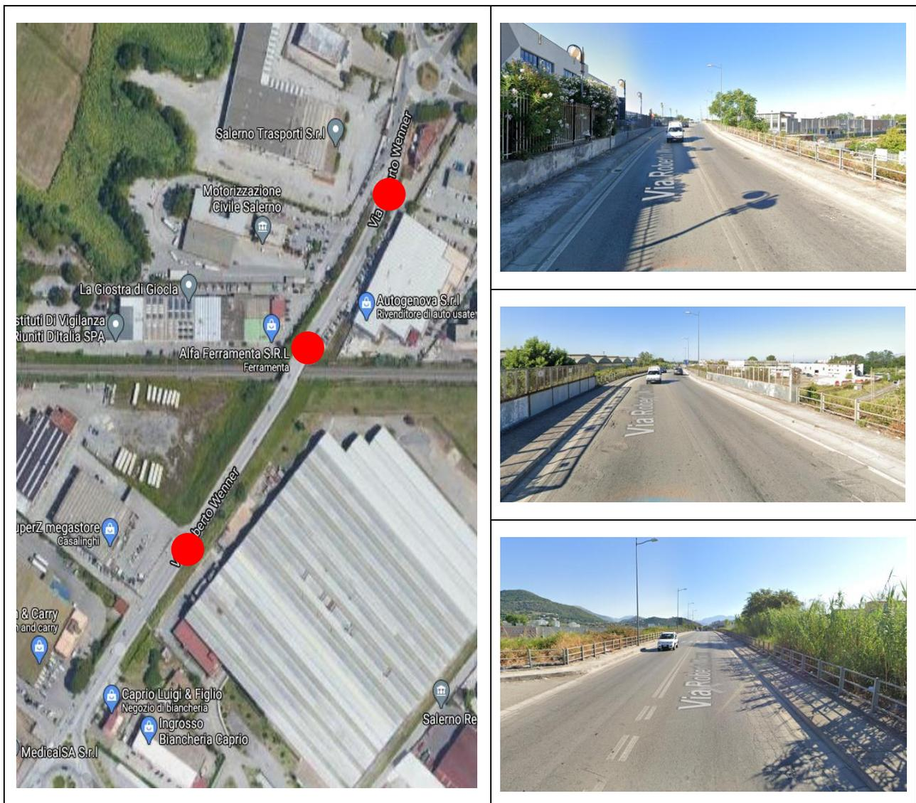
L'intervento è limitato alla sola modifica dell'andamento altimetrico della strada esistente, e consiste nell'innalzamento della livelletta ad un valore di pendenza massima pari a 4.2% rispetto al 2.6% (valore della
