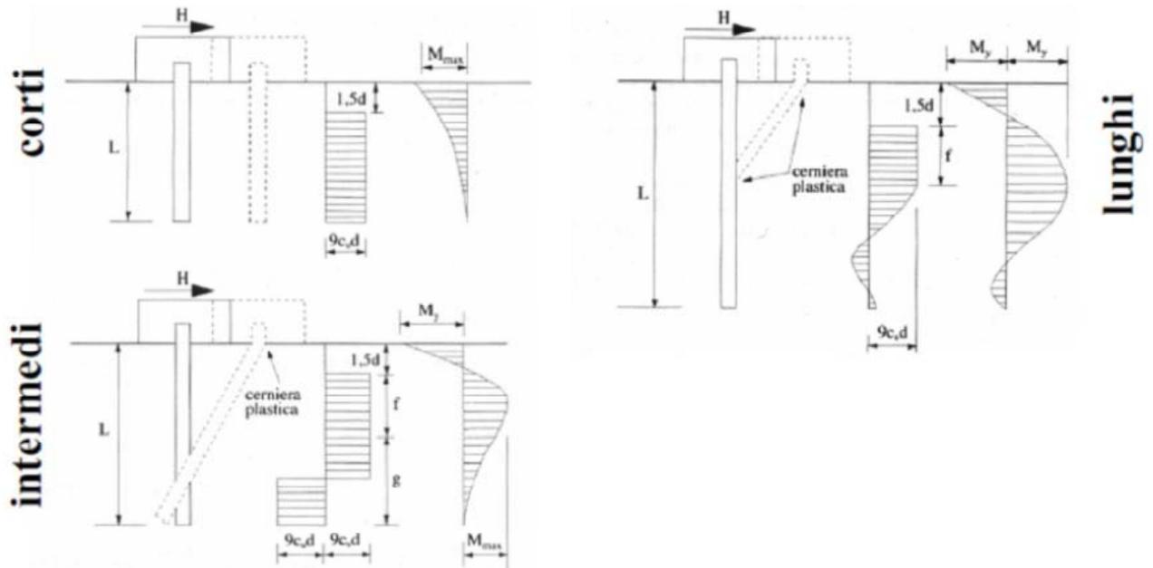
Figura 4: Carico limite trasversale: terreni coesivi
