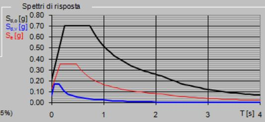
— Spettro di progetto - componente orizzontale
