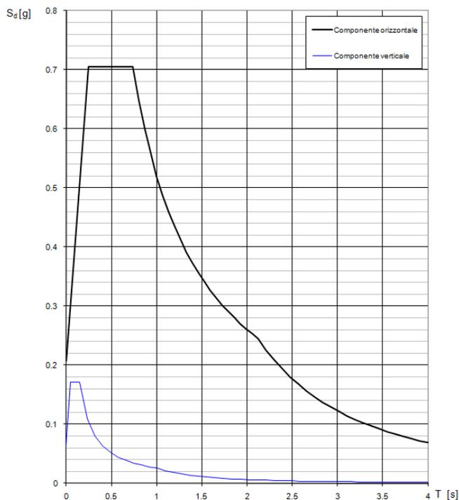
**Parametri e punti dello spettro di risposta orizzontale per lo stato SLV**
