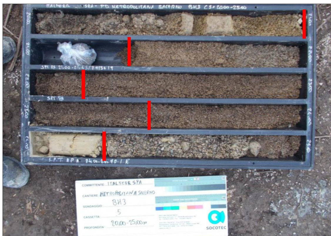
Figura 6.31 – Esempio cassetta, unità GHIAIA
