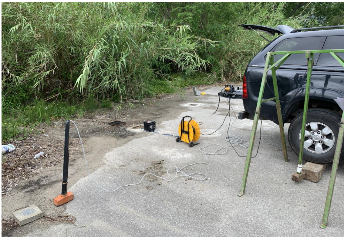
Figura 83: foto relativa all'esecuzione della prova down-hole BH 06
