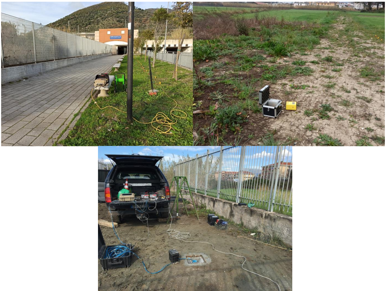
Figura 2: Strumentazione impiegata per le prove sismiche mediante metodologia MASW (in alto a sinistra), HVSR (in alto a destra) e down-hole (in basso).
