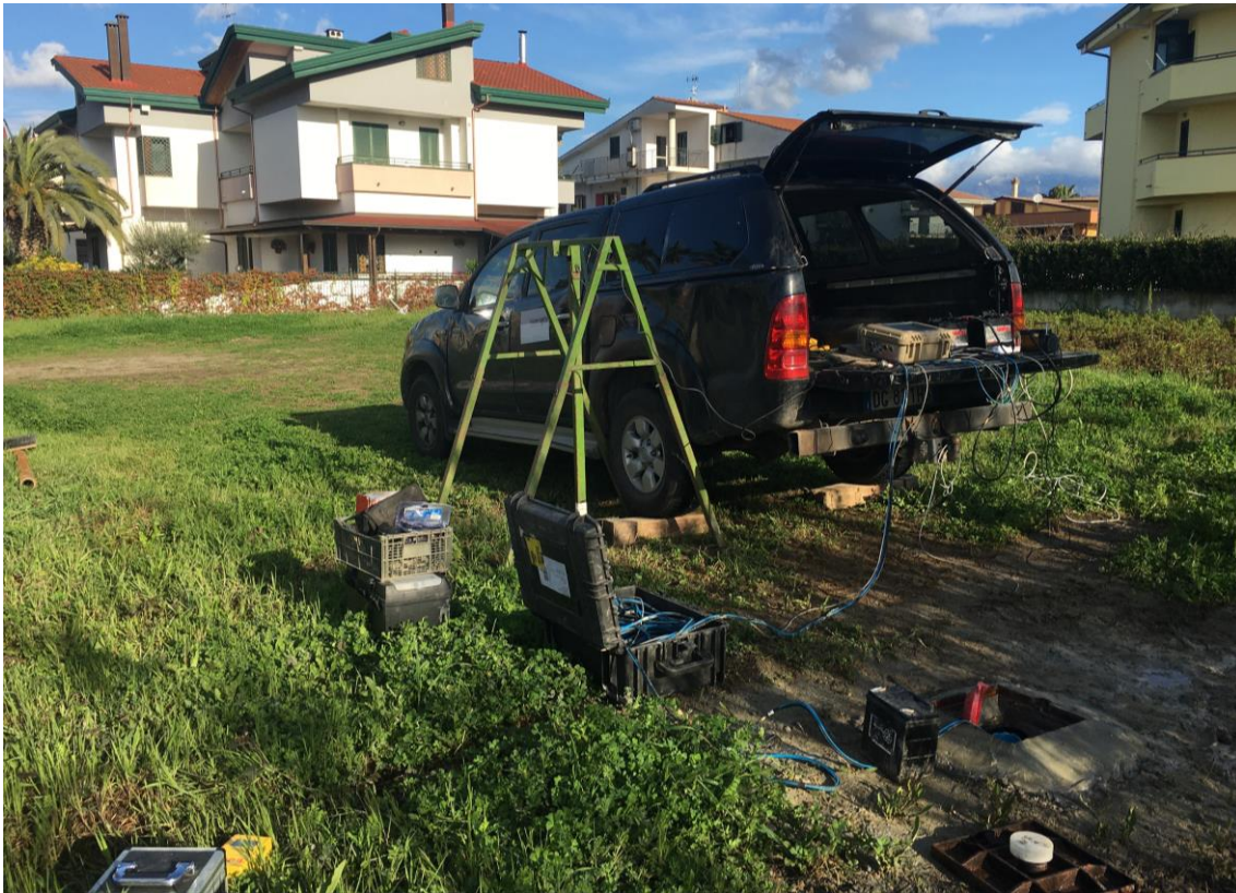
Figura 63: foto relativa all'esecuzione della prova down-hole BH16.
