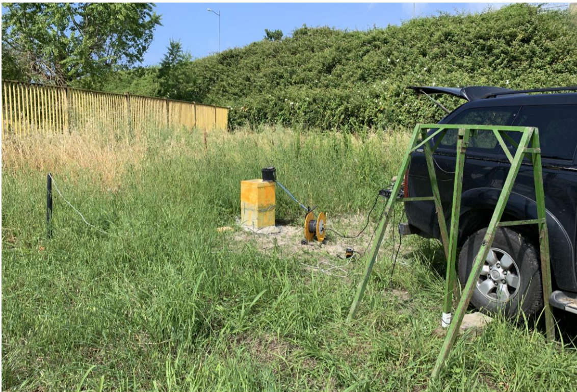
Figura 88: foto relativa all'esecuzione della prova down-hole BH 08.
