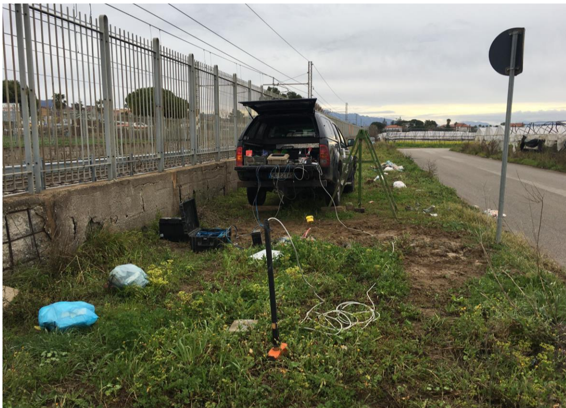
Figura 78: foto relativa all'esecuzione della prova down-hole BH24.
