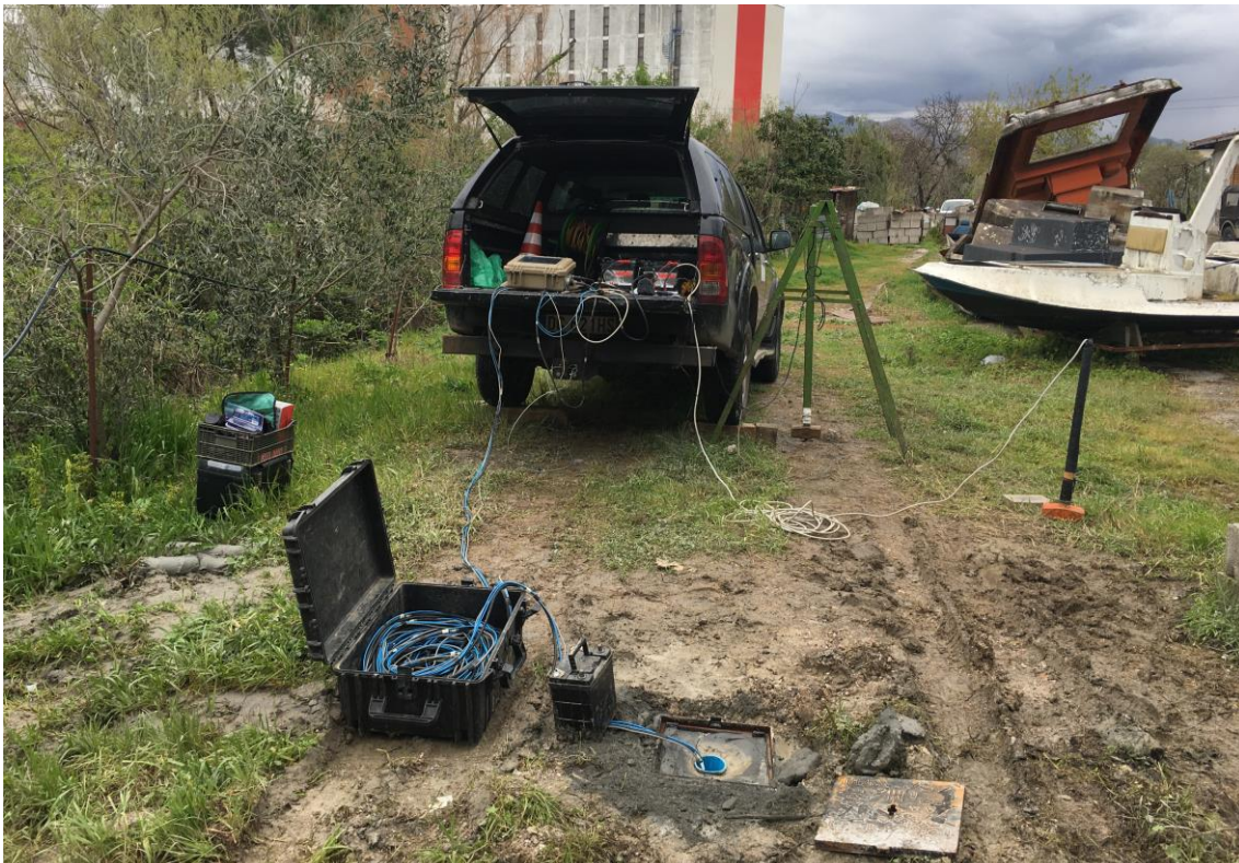
Figura 68: foto relativa all'esecuzione della prova down-hole BH19.
