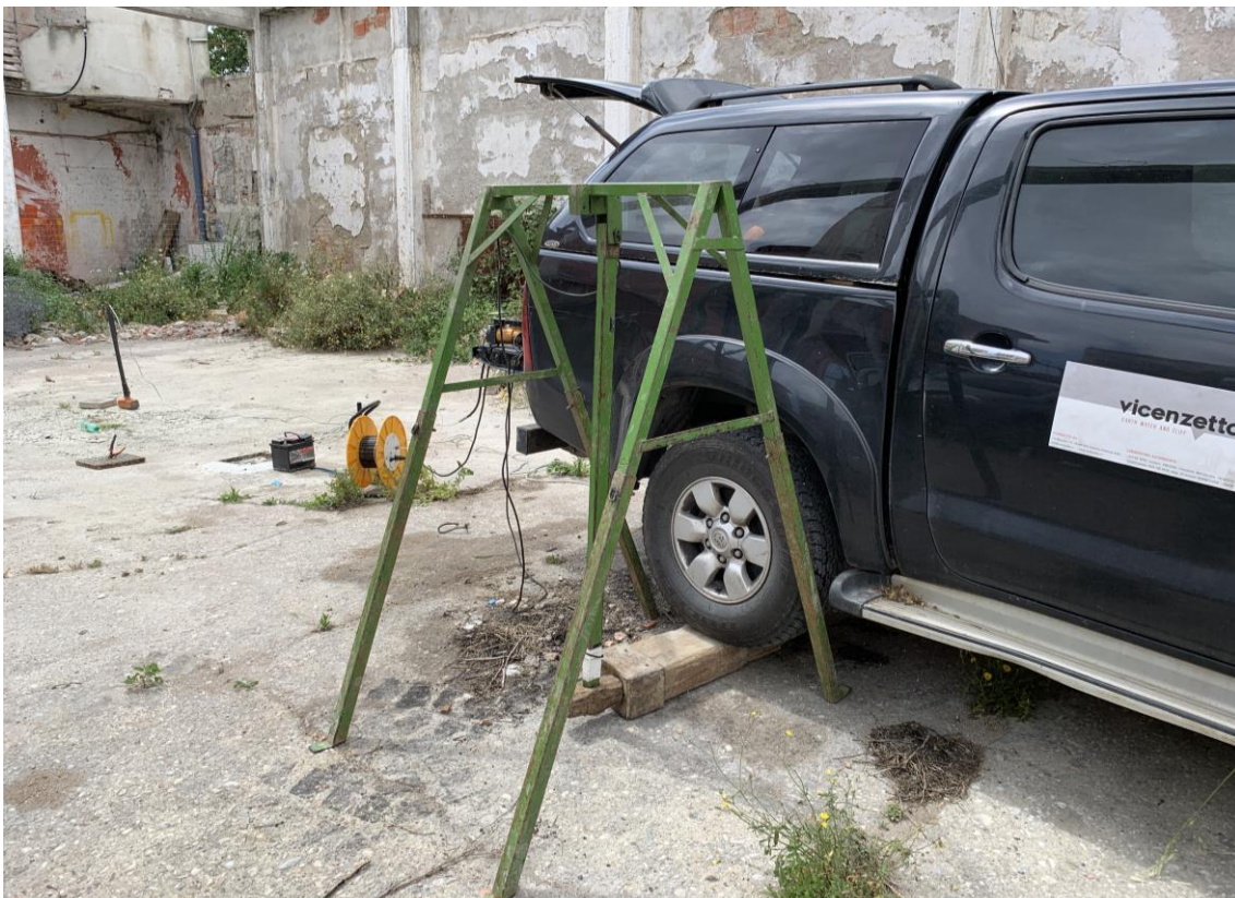
Figura 93: foto relativa all'esecuzione della prova down-hole BH 12.
