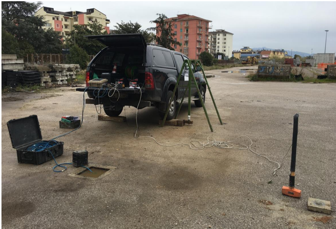
Figura 58: foto relativa all'esecuzione della prova down-hole BH13.
