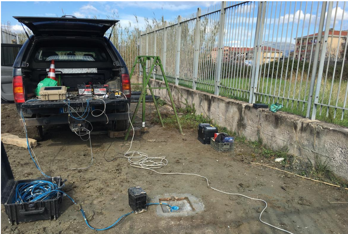
Figura 73: foto relativa all'esecuzione della prova down-hole BH23.
