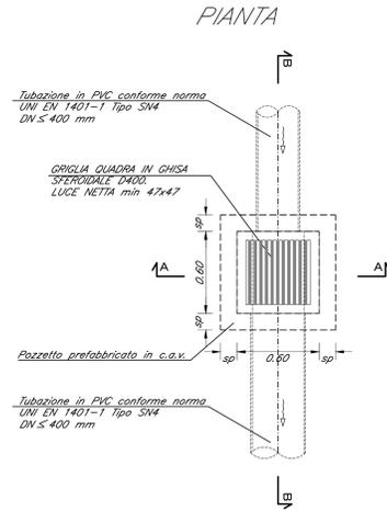
POZZETTO TIPO GRIGLIATO (DN≥400 mm)
