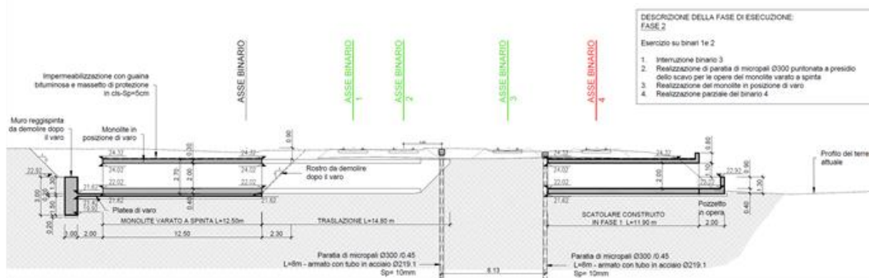
Figura 9: Tombino IN16 – fasi di costruzione
