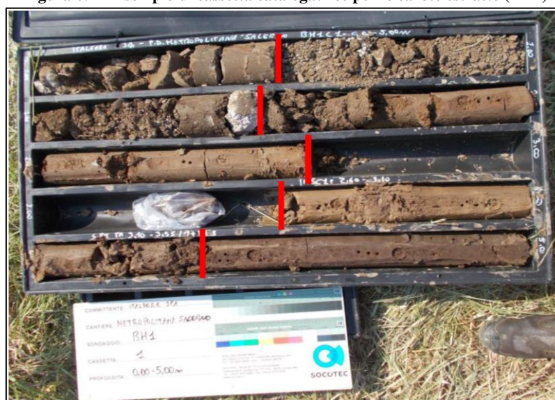
Figura 6.1 – Esempio di cassetta catalogatrice per le carote estratte (BH1)
