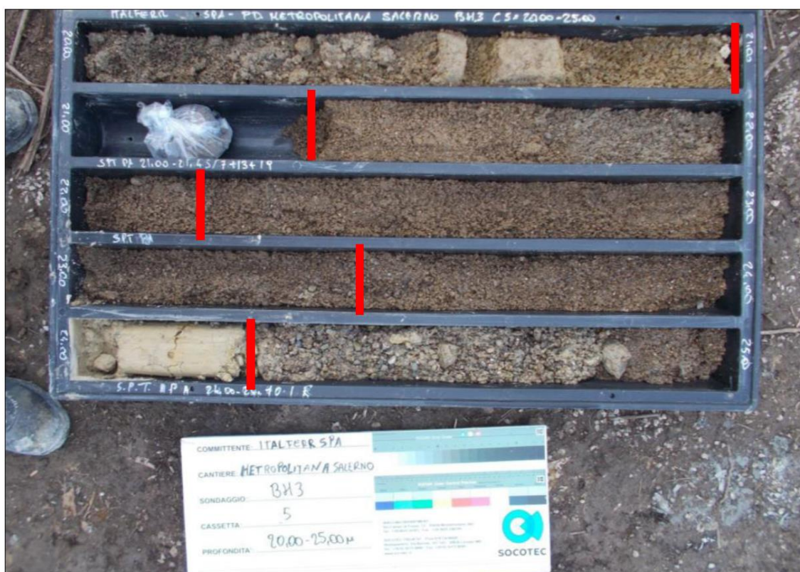
Figura 7.31 – Esempio cassetta, unità GHIAIA
