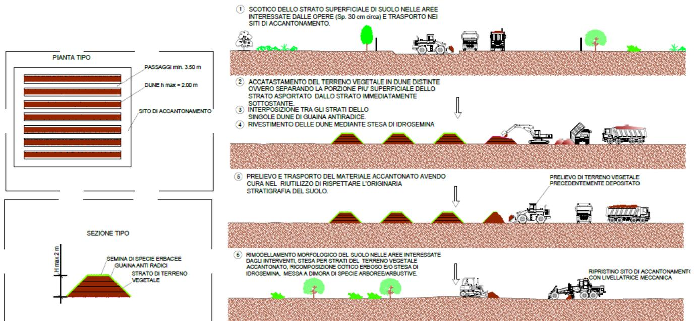
Figura 3-1: Schema di accantonamento del terreno vegetale
