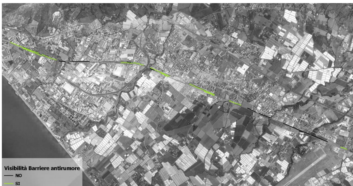
Figura 4-16 Localizzazione delle barriere antirumore in relazione alle condizioni di visibilità dai luoghi di normale accessibilità
