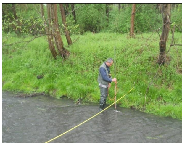
Figura 3.2/4 - Misura di portata con mulinello ordinario (rio Ribes).
