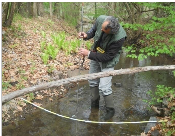
Figura 3.2/3 - Misura di portata con micromulinello (Borra della Massa)
