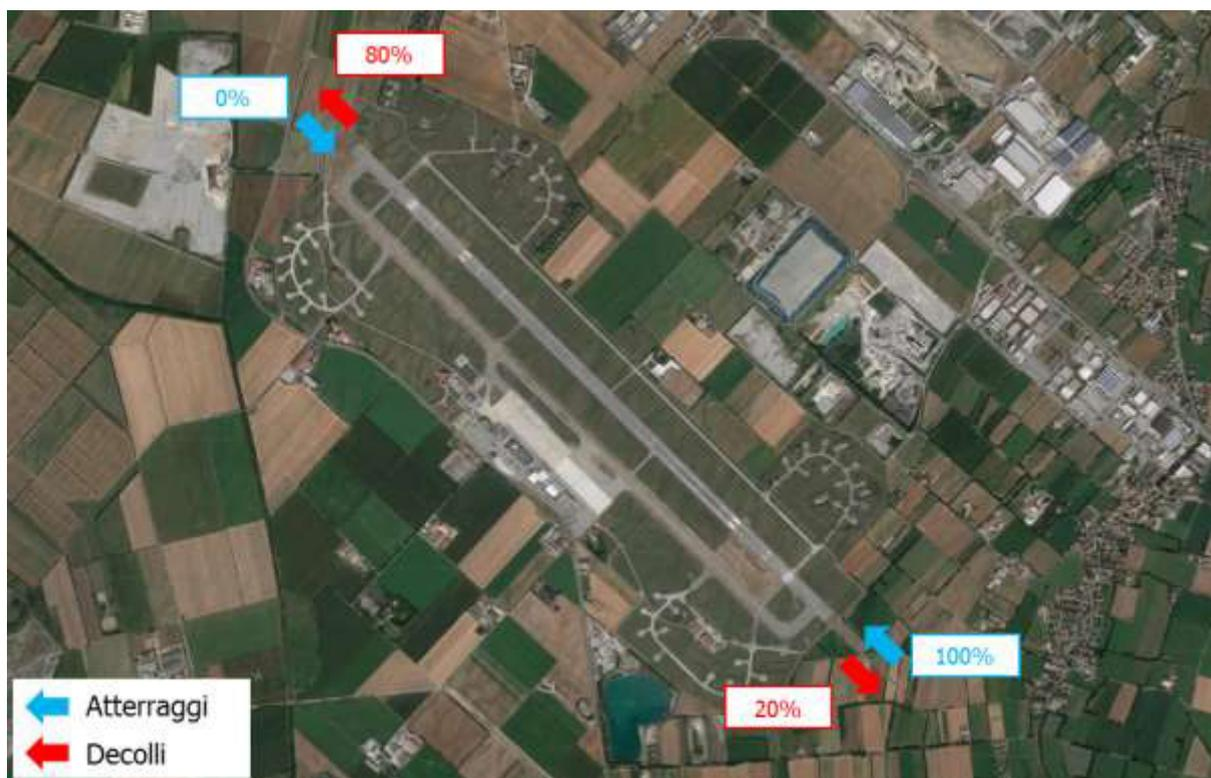
Figura 3-2 Modalità di uso dell'infrastruttura di volo assunta nel modello di simulazione per lo scenario operativo 2030
