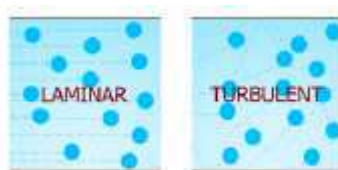
Figura 18: Confronto tra flusso laminare e flusso turbolento
