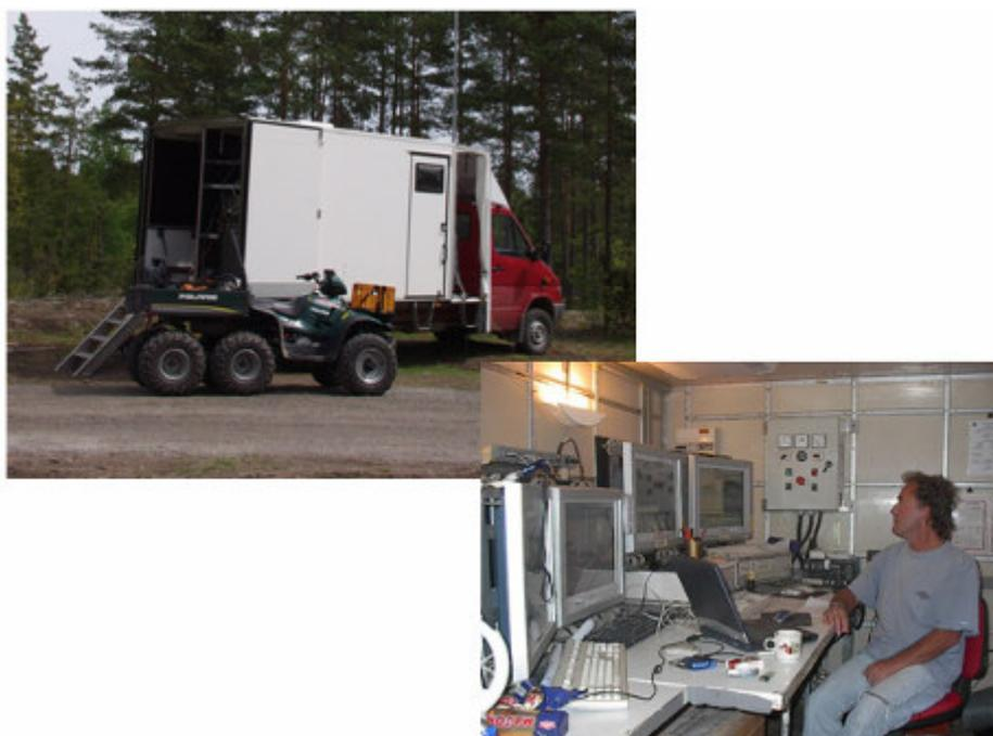
**Figura 2.3-5: apparecchiatura di registrazione dei segnali geosismici**
