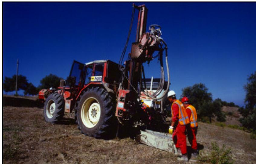
**Figura 2.3-7: perforatrice “convenzionale” su trattore 4x4 operante con fango bentonitico**
