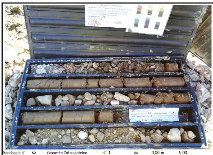
Figura 16. Materiali alluvionali terrazzati in corrispondenza della spalla – Sondaggio S2
