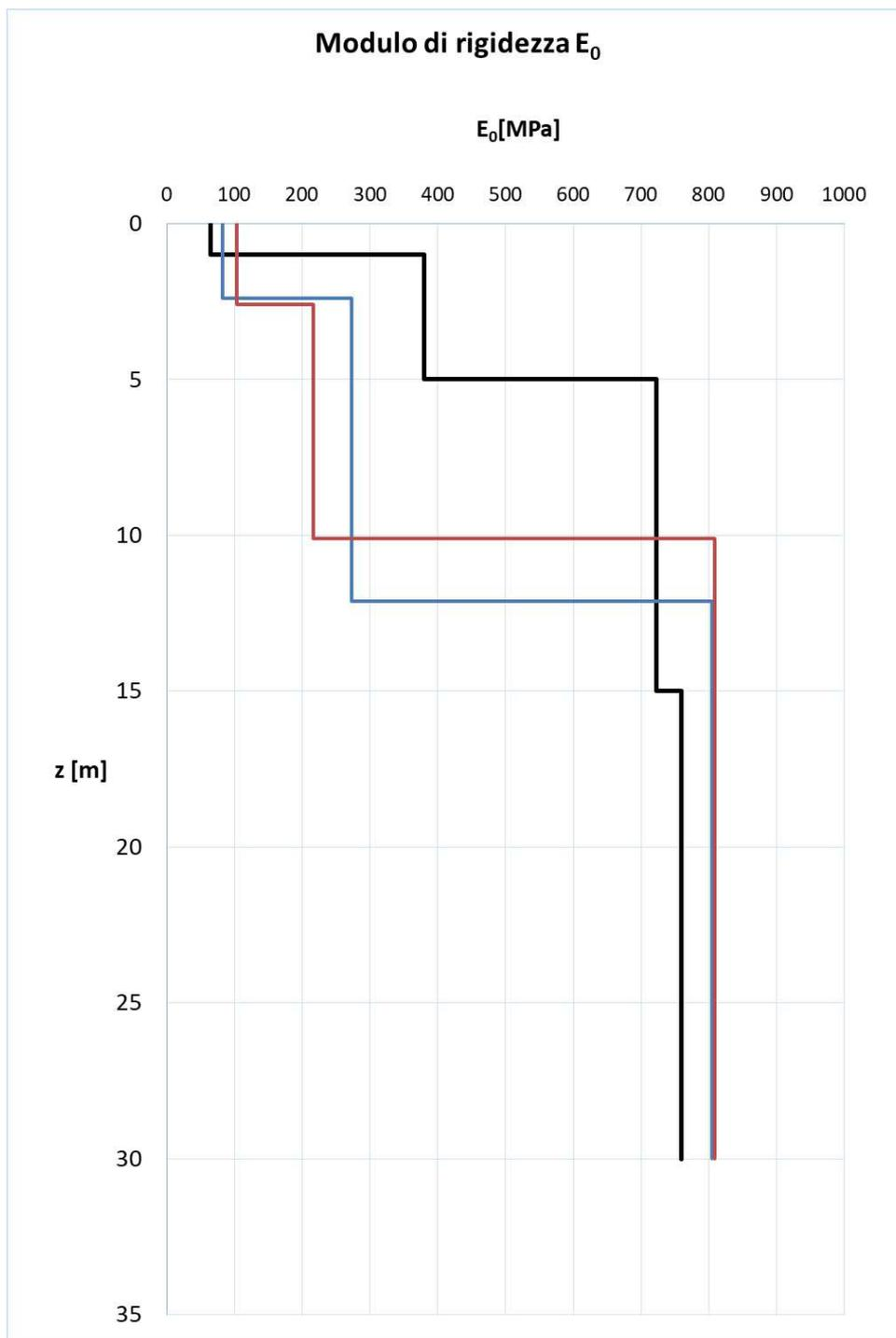
Figura 8. OS 82 - Modulo di rigidezza a piccole deformazioni
