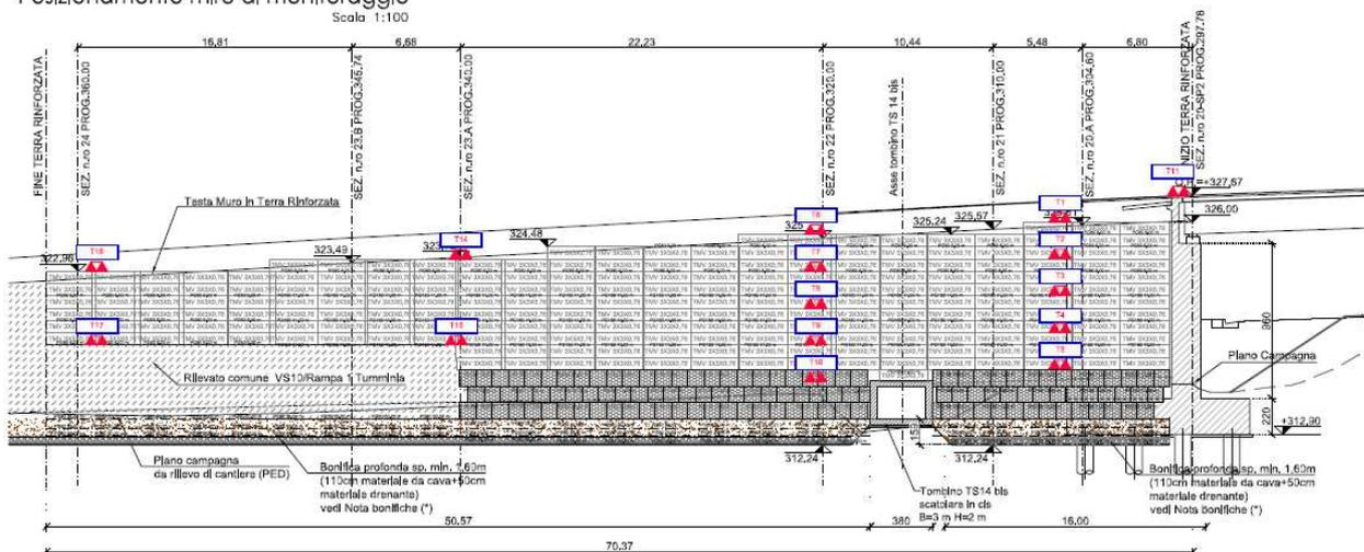
Figura 26 – Prospetto punti di mira terra rinforzata
