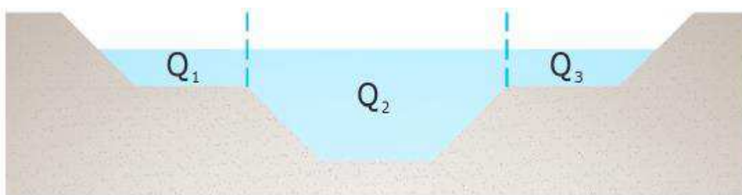
Figura 18: Suddivisione delle portate in una sezione tipo
