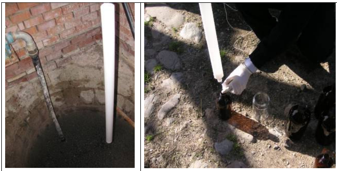
Figura 3.5-9: Campionamento mediante bailer monouso
