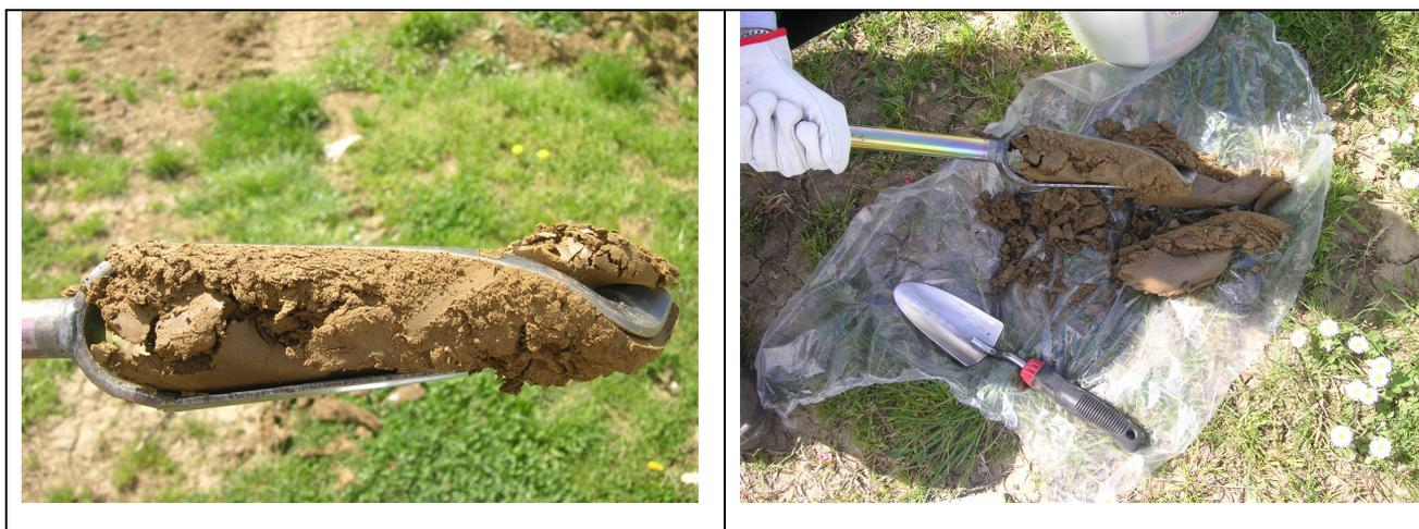
**Figura 3.5-1: Campione prelevato con trivella manuale Edelman**
