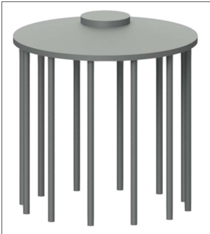
Figura 1: vista tridimensionale della fondazione dell'aerogeneratore
