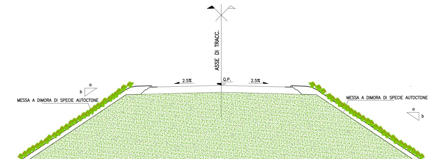
SISTEMAZIONE A VERDE SEZIONE TIPO IN SCAVO
