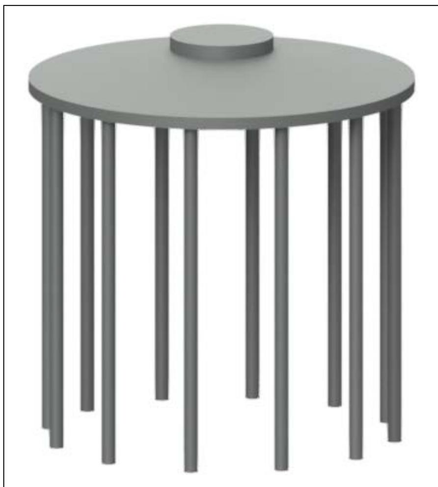
**Figura 7: vista tridimensionale della fondazione dell'aerogeneratore**
