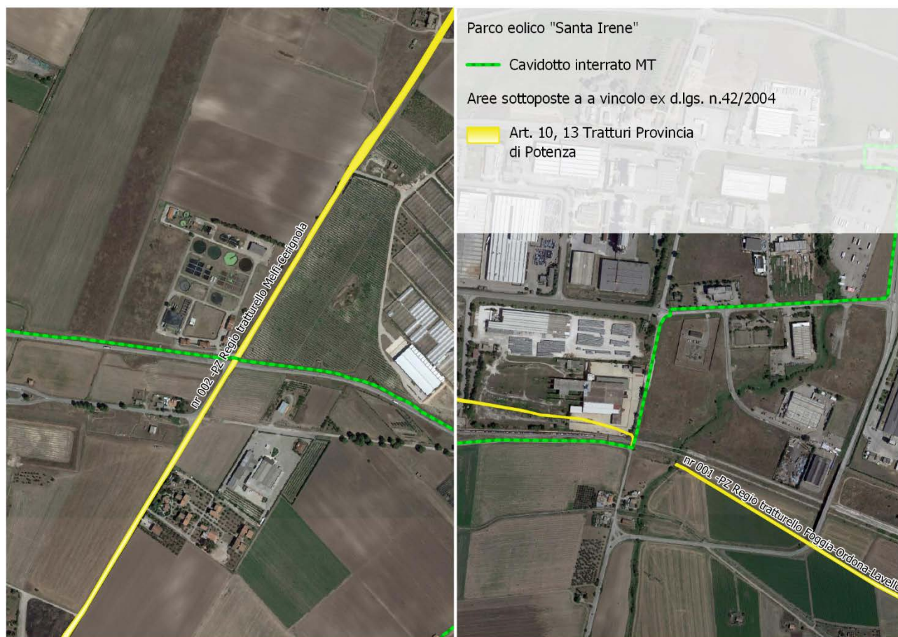
Figura 18: Ingrandimenti interferenza del cavidotto di connessione con il "Tratturo Foggia-Ortona-Lavello" (nr 001 – PZ) ed il "Tratturo da Melfi-Cerignola" (nr 002 –PZ)
