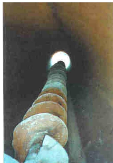
**Fig. 4.3 - Coclea per trivella spingitubo.**
