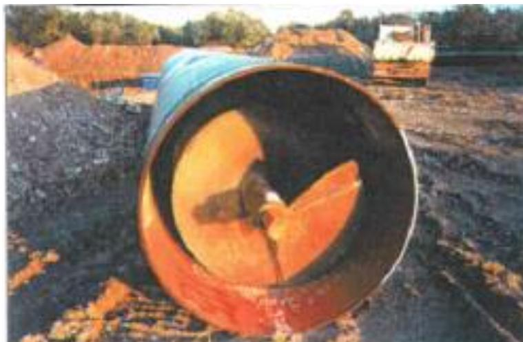
**Fig. 2.1 - Coclea per trivella spingitubo**
