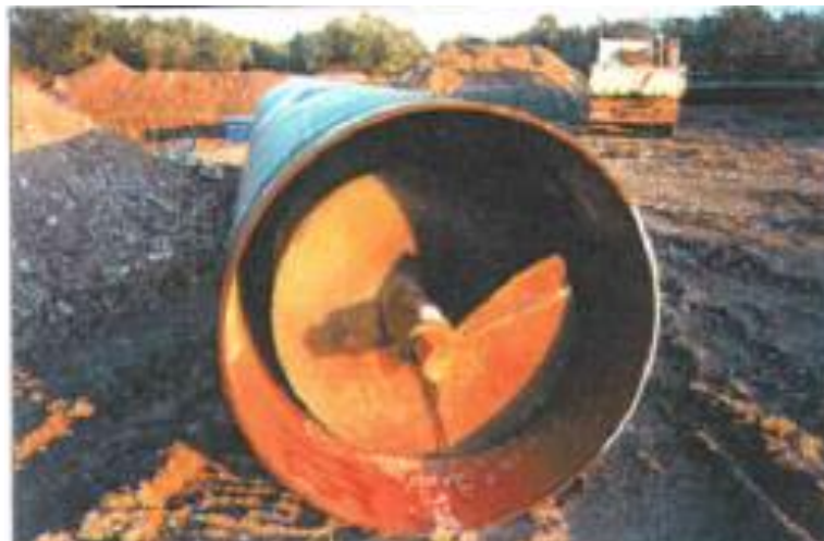
Fig. 6.1 - Coclea per trivella spingitubo
