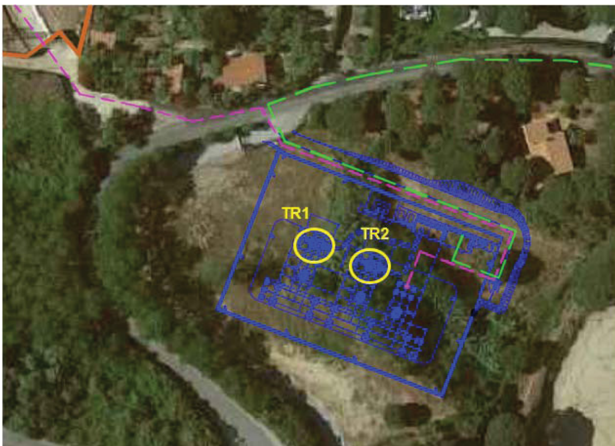
Figura 4.2-2 – Immagine satellitare con planimetria della stazione elettrica utente e con indicazione delle due sorgenti di rumore (in giallo)
