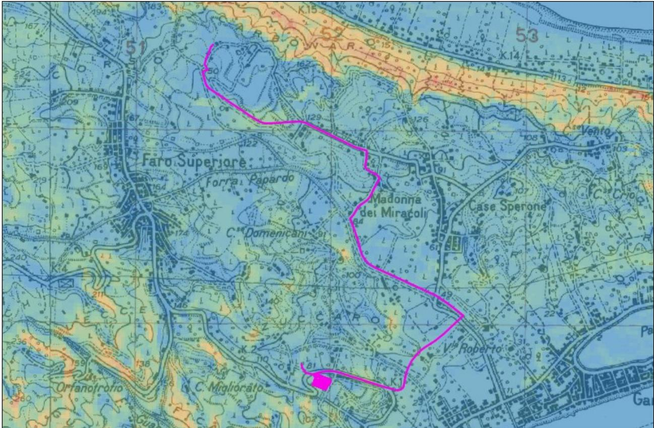
**Figura 8: Sovrapposizione fra carta in scala 1:25000 e Carta delle pendenze (ricavata dal DTM passo 20 m) in falsi colori. Tematismi tratti dal Geoportale Nazionale. Si riconosce molto bene l'ampia scarpata posta a nord della Centrale Snam Rete Gas di Faro Superiore.**
