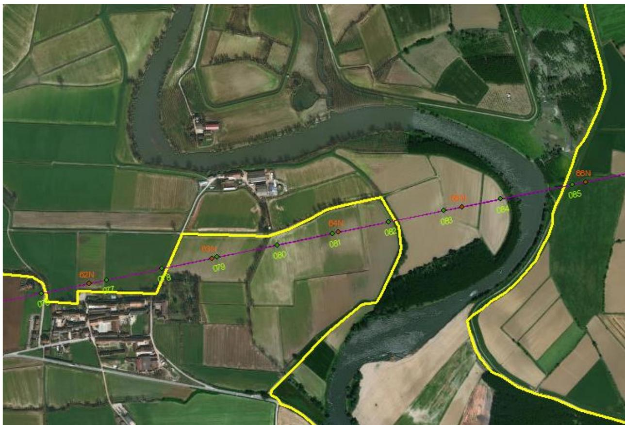
**Figura 6-2 Stralcio su ortofoto con localizzazione dei sostegni da demolire (in verde) e di nuovo impianto (in arancione); il contorno giallo indica il perimetro della ZPS**
