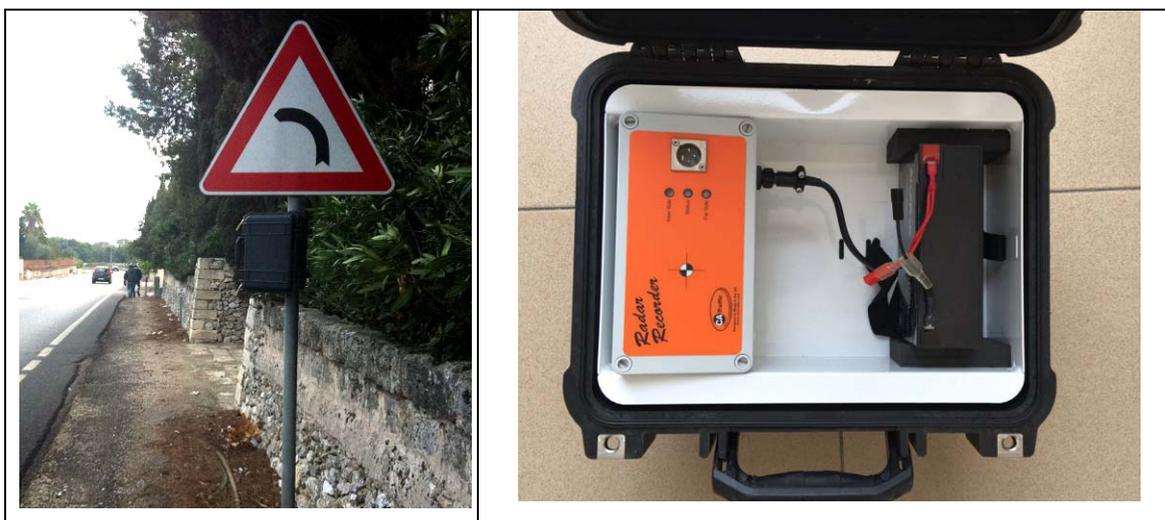
Figura 3 Strumentazione per il rilevamento del traffico
