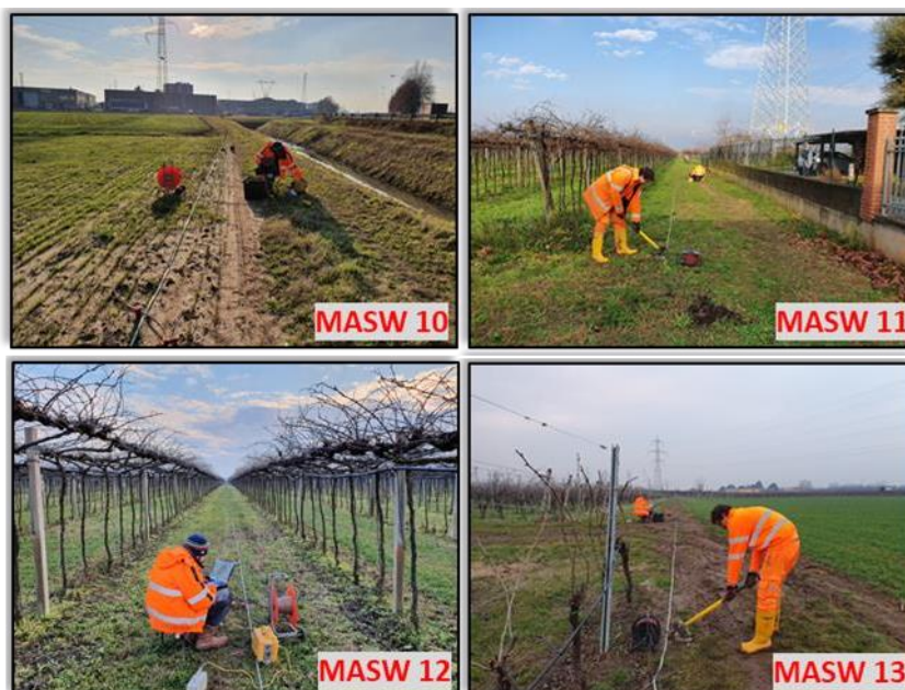
Figura 5 - Fasi di acquisizione
