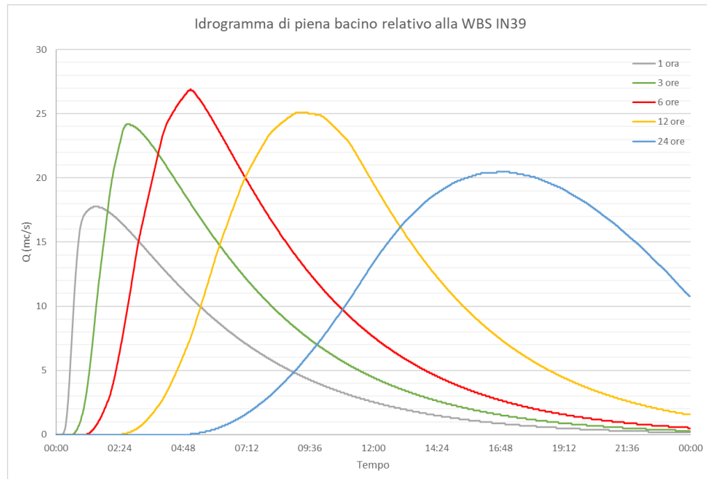
Figura 5-18 Idrogramma di piena del bacino relativo alla WBS IN39 per un Tr di 300 anni
