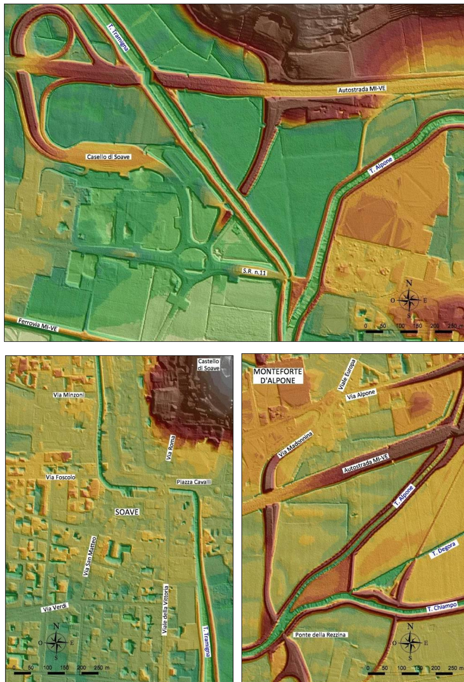
Fig. 4.2 - Particolari della rappresentazione a scala di colori ed a luci e ombre dei dati altimetrici originali rilevati in volo con la tecnica laser-scanner (LIDAR) nella zona della confluenza Tramigna-Alpone, nell'abitato di Soave e nella zona della confluenza Chiampo-Alpone.
