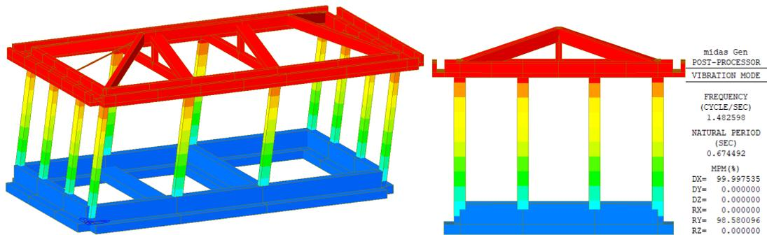
Figura 13 1° Modo di vibrare, periodo 0.6745 s, frequenza 1.4826Hz
