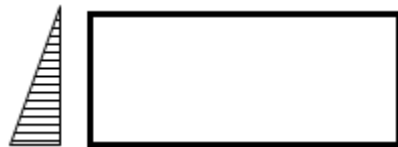
Figura 8 – diagramma di spinta elementare – s5=1
