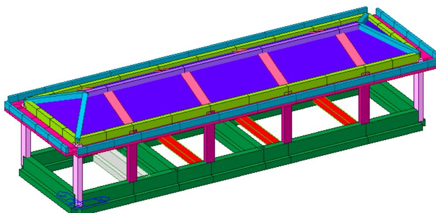
Figura 6 Modello FEM Midas Gen del fabbricato in oggetto
