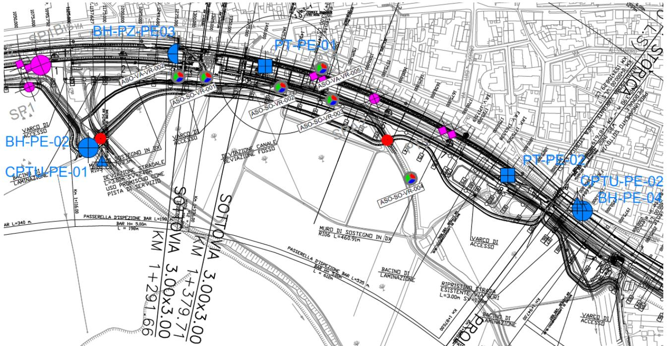
Figura 3: Stralcio planimetrico – Ubicazione indagini geotecniche di riferimento per le opere in esame (in rosso posizionamento Ponte NV54 – Tombino NV54)
