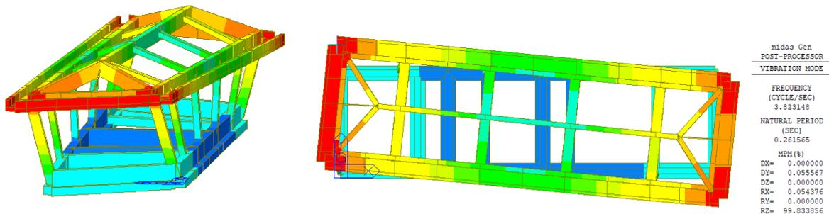
Figura 13 2° Modo di vibrare, periodo 0.2616 s, frequenza 3.8231 Hz
