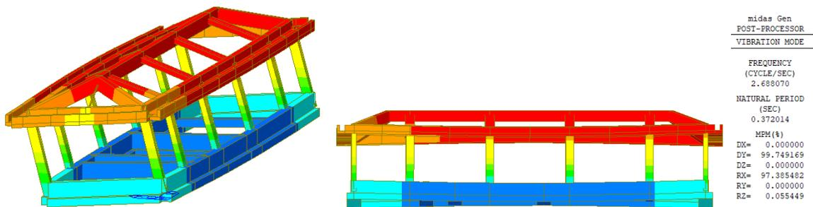
Figura 12 1° Modo di vibrare, periodo 0.3720 s, frequenza 2.6881Hz
