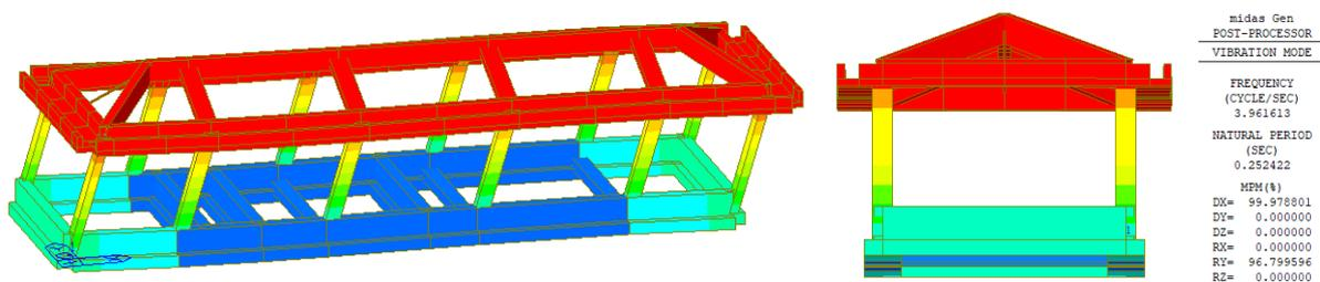
Figura 14 3° Modo di vibrare, periodo 0.2524 s, frequenza 3.9616 Hz
