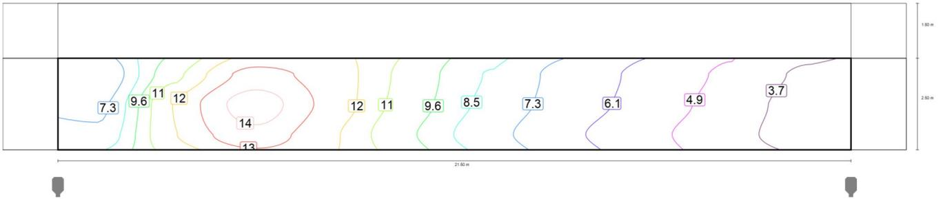
Valore di manutenzione illuminamento verticale (ovest) [lx] (Curve isolux)
