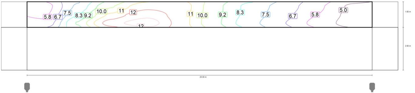
Valore di manutenzione illuminamento verticale (ovest) [lx] (Curve isolux)
