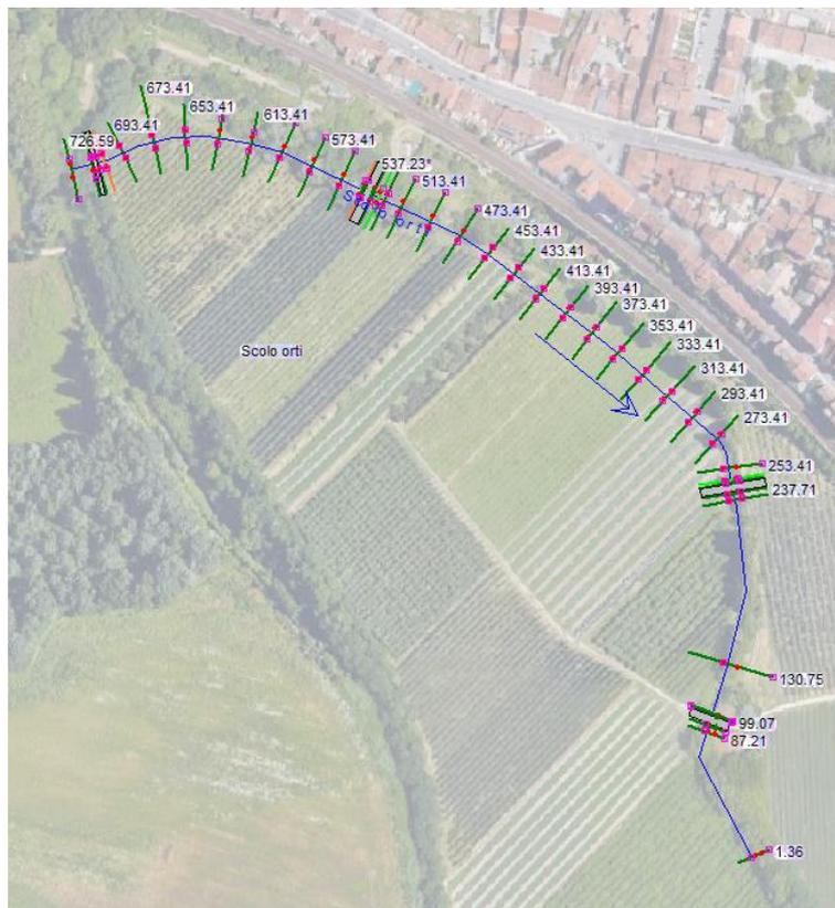
Figura 10-5 Planimetria di modellazione dello scolo Orti, post operam
