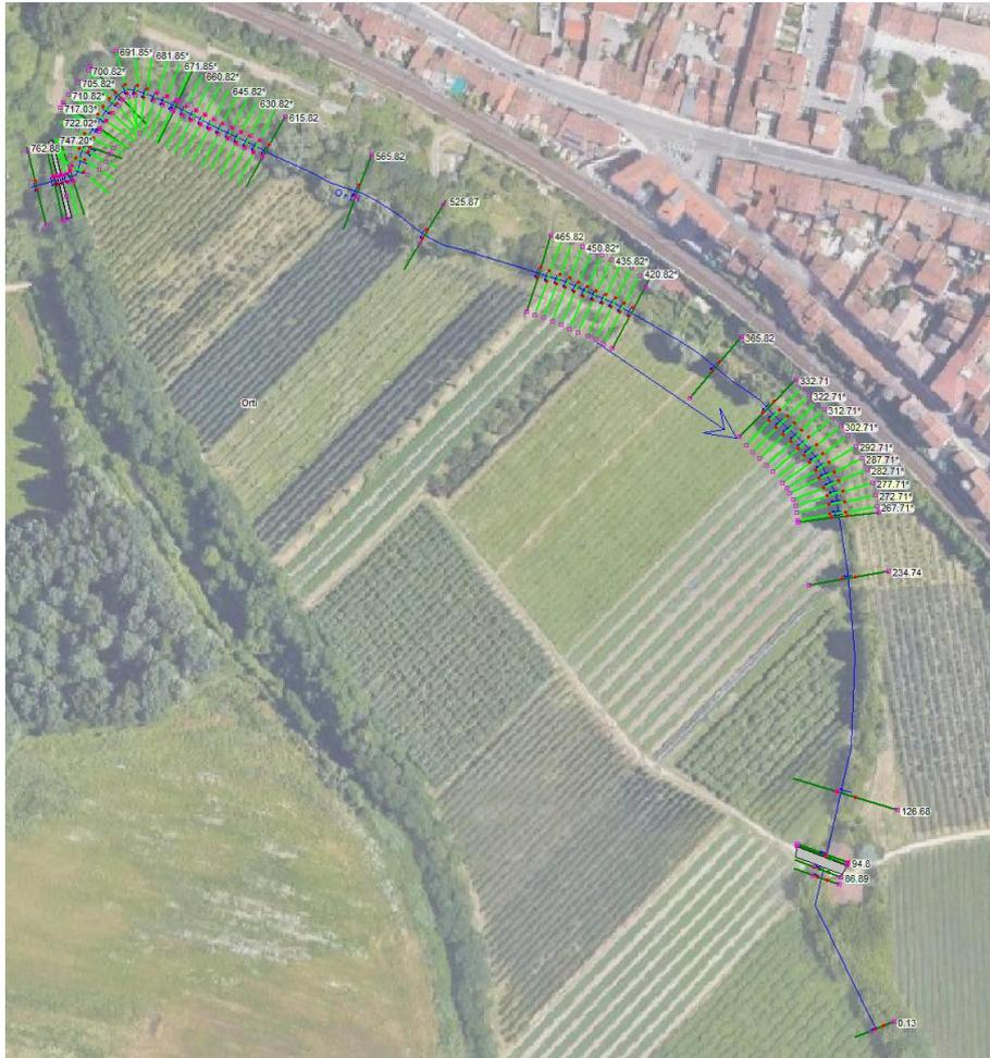
Figura 10-2 Planimetria di modellazione dello scolo Orti, ante operam
