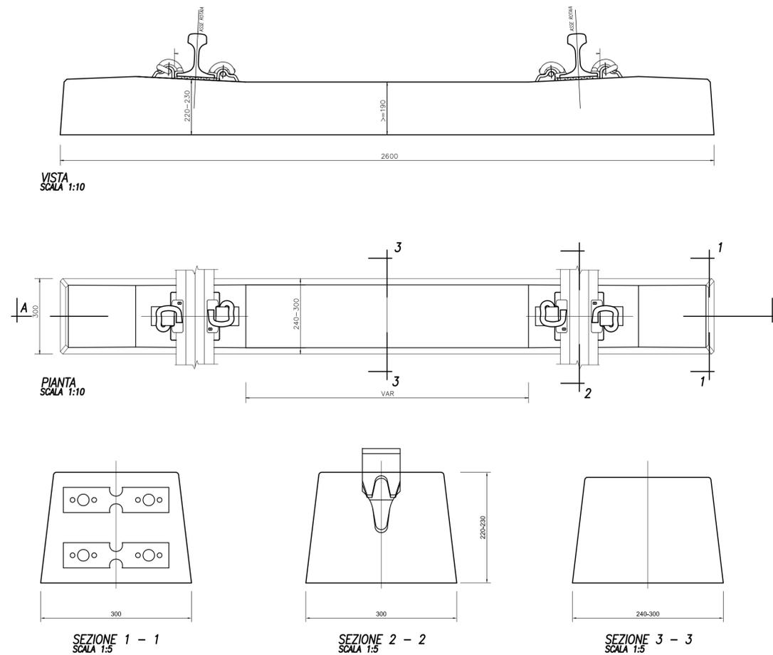
LE TRAVERSE DEVONO ESSERE CONFORMI ALLA SPECIFICA TECNICA DI FORNITURA RFI TCAR SF AR 03 002 F
