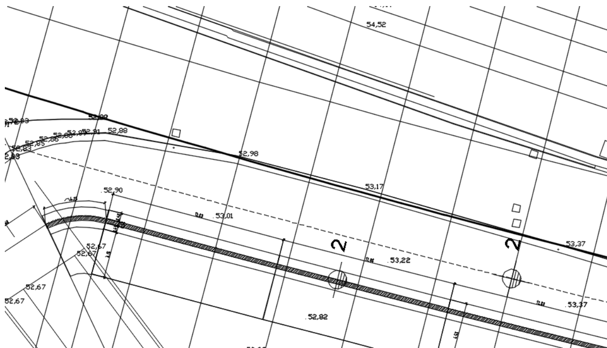
Figura 1.1: Stralcio planimetrico del muro di sostegno della deviazione IN05
