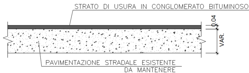
Figura 7: Pacchetto pavimentazione Via Campagnole lato ovest
