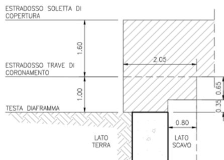
Figura 6 Sezione trasversale nodo di copertura
