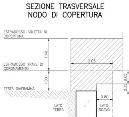
Figura 6 Sezione trasversale nodo di copertura
